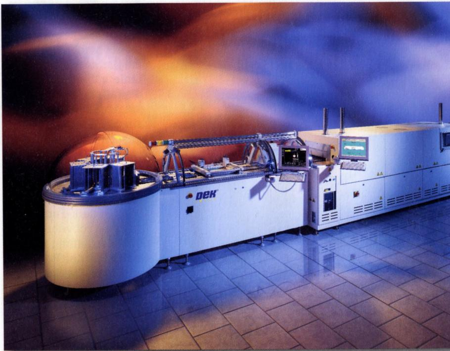
Bild 3: Produktionslinie PVP 1200 für die Metallisierung von Photovoltaik-Wafern
